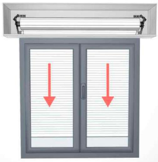
6/ Laisser et point de commande en position "Descendre". Ajuster la position de la butée basse en tournant la vis de réglage vers le +.
