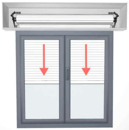
4/ Laisser le point de commande en position "Monter". Afin de repérer la butée haute, tourner une des vis de réglage vers le +. Si le volet remonte, cette vis de réglage est bien celle de la butée haute. Si le volet ne bouge pas, cette vis de réglage est celle de la butée basse. Ajuster la position de la butée, repérée précédemment, en tournant la vis de réglage vers le +.
