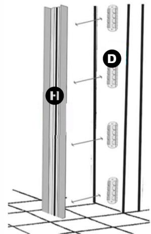
**7** Vissez les 4 plaques de fixation (D) du côté opposé. *Il est recommandé ne pas utiliser un visseuse.*
