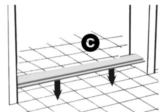
**9** Alignez la partie fixe du corps de la plissée (A) dans les plaques de fixation (D) et pressurez.
