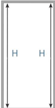
**3** Vérifier la mesure de la hauteur du creux (H) sur deux points différents. La plus petite d'entre elle sera la correcte.
