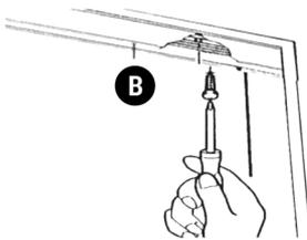
Vissez les 4 plaques de fixation (D). Alignez le profil et pressurez.
